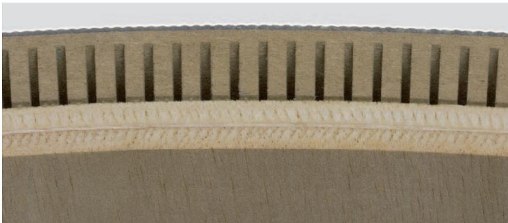
Ein ausgeklügelter Gehäuseaufbau sorgt für Steifigkeit und verringert Eigenresonanzen auf ein Minimum. Gehäusehärte und Schalldämmung nehmen bei dieser mehrschichtigen Konstruktion nach außen hin zu. Das Ganze wird noch optimiert, indem die Hohlräume mit 8 kg feinkörnigem Quarzsand aufgefüllt werden.
