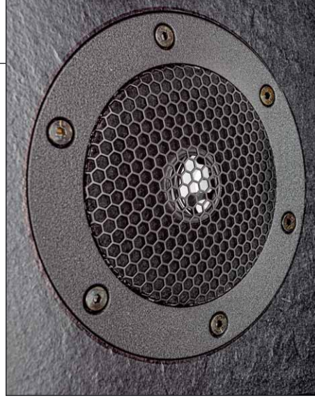
Sieht unspektakulär aus, hat's aber in sich: der Diamanthochtöner mit 20 mm Membrandurchmesser
