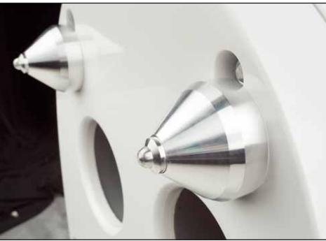
Spikes entkoppeln die 85 Kilogramm schwere Box vom Boden, ihre Höhe hat Einfluss auf die Basswiedergabe
