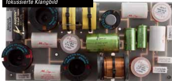
Ein symmetrischer Aufbau der Frequenzweiche sorgt für das fokussierte Klangbild
