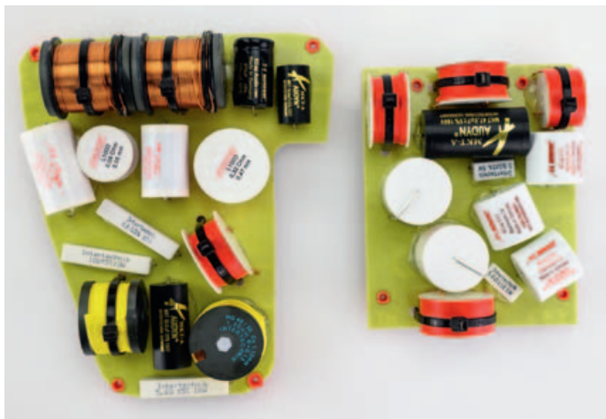
Die Frequenzweiche beinhaltet stolze 28 Bauteile ausgesuchtester Qualität, die Bass-Extension-Schaltung kann extern aktiviert werden.
