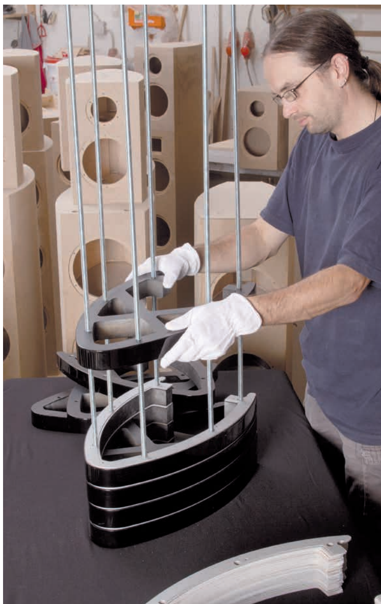
Die Rippen werden zunächst locker gestapelt. Den für die Stabilität notwendigen Druck erzeugen die Stangen.
