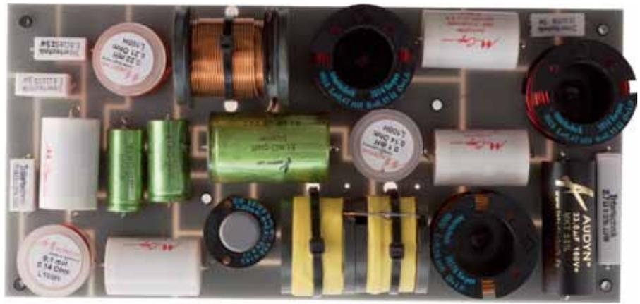
Die Frequenzweiche der Arcona 40 ist symmetrisch aufgebaut, was bedeutet, dass am Plus- und Minusweig gleich große Bauteile sitzen. Das Konzept bringt eine gleichmäßigere Belastung des Verstärkers, der den Rückstrom des Lautsprechers kurzschließt
