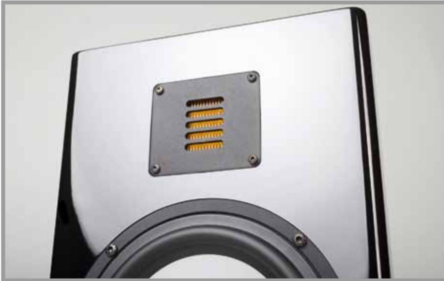
Die Arcona 40 ist mit einem Air-Motion-Transformer ausgestattet, der von einem Eisen-Neodym-Bor-Magneten angetrieben wird. Die Folienmembran ist Ziehharmonika-förmig gefaltet und mit mäanderförmigen Leiterbahnen bedruckt
